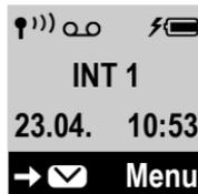
Ist der Modus **Strahlg. aus** (→ S. 24) aktiviert, wird im Display oben links das Symbol angezeigt.
